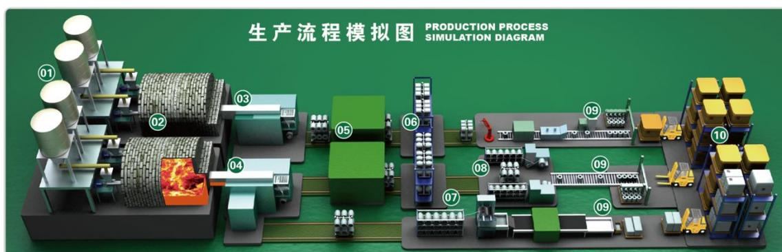
玻璃纤维是一种性能优异的无机非金属材料，种类繁多，优点是绝缘性好、耐热性强、抗腐蚀性好，机械强度高，通常用作复合材料中的增强材料，电绝缘材料和绝热保温材料，电路基板等国民经济各个领域，是国家重点鼓励发展的新材料产业。它是叶腊石、高岭土、石灰石、石英砂等矿石为原料（上图 1 各种矿石按照比例配制）经高温熔制（上图 2）、拉丝（上图 3 和 4）、烘干（上图 5）、络纱（上图 7）等工艺制造而成，其单丝直径为几微米到二十几微米，相当于一根头发丝的  $1/20-1/5$ ，每束纤维原丝都由数百根甚至上千根单丝组成。玻璃纤维主要成分为二氧化硅、氧化铝、氧化钙、氧化硼、氧化镁、氧化钠等，根据玻璃中碱含量的多少，可分为无碱玻璃纤维、中碱玻璃纤维和高碱玻璃纤维，其中无碱玻璃纤维占据 95% 以上的产量规模。
